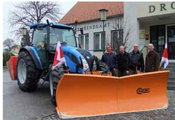
Ausgestattet wurde der Traktor mit einem Schneepflug mit ca. 2,4 m Räumbreite sowie einer Frontladerkonsole der Firma Hauer aus Statzendorf.
